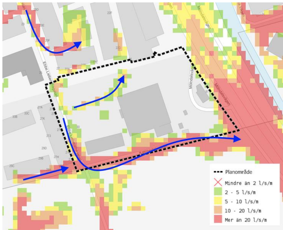
Figur 14. Flöden (l/s/m) nuläge för klimatanpassat 100-årsregn (2017) (källa: GoKart).
