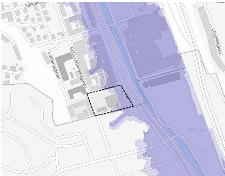
Figur 17. Vattennivå 200-årsflöde (mörkblå yta) och maxflöde (ljusblå yta) i Mölndalsån.
