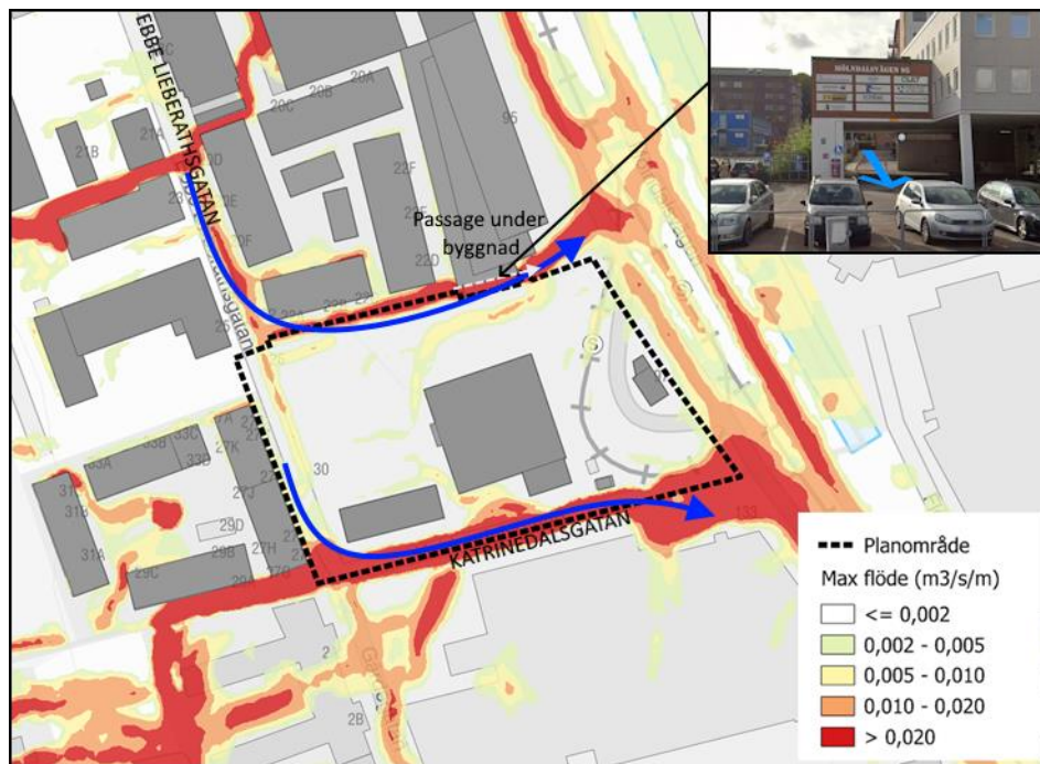
Figur 15. Maxflöden för befintlig situation vid klimatanpassat 100-årsregn.
